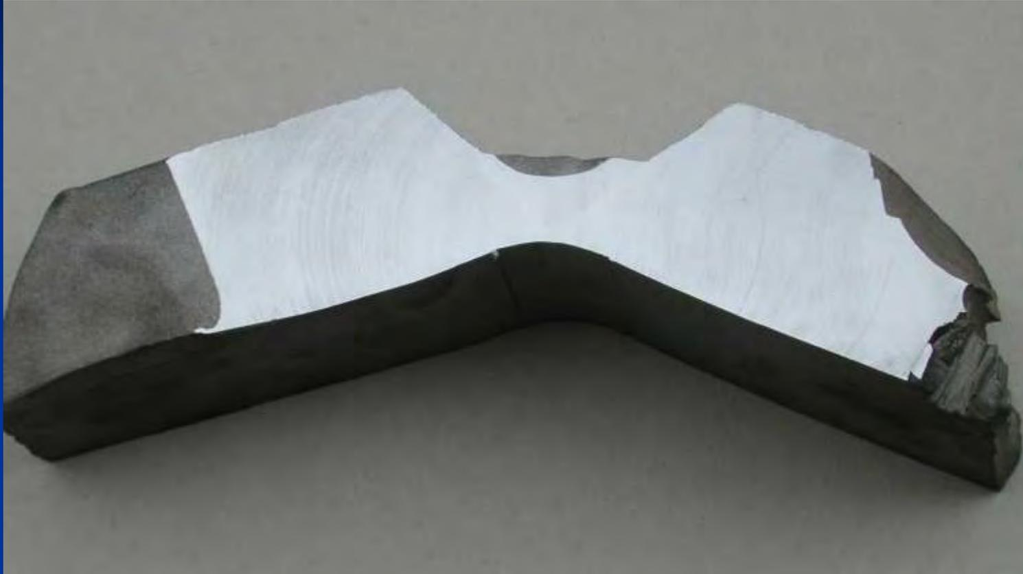
Probeschweißung und Biegeversuch an
